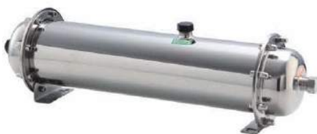
B-312-8 HY-UF-1500不銹鋼管中空絲膜淨水器(內含KDF) 6分外牙 1500公升/時
